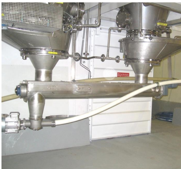
Horisontell trågskruv med dubbla inlopp. Till utloppet är en flexibel skruvtransportör ansluten.
