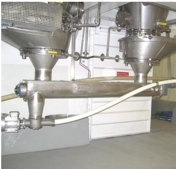
Horisontell trägskruv med dubbla inlopp. Till utloppet är en flexibel skruvtransportör ansluten.
