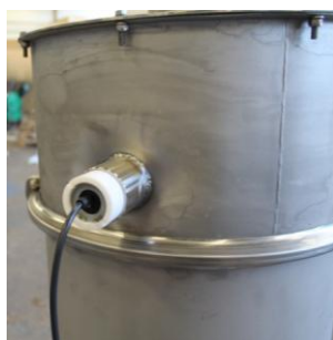
Kapacitiv givare i behållare - överfyllnadsskydd.
