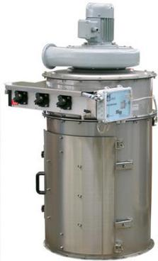
WAMFLO®-filter har en cylindrisk form, tillverkad av rostfritt stål med flänsanslutning som innehåller vertikalt monterade filterelement. Det självrengörande jetstrålesystemet är integrerat i den övre kåpan. WAMFLO®-filter finns med eller utan utsugsfläkt.
