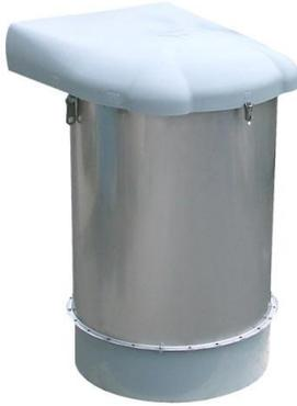
SILOTOP® är ett cylinderformat filter för ventilering av pneumatiskt fyllda silor. Den rostfria stål kroppen innehåller vertikalt monterade filterelement. Systemet är självrengörande med hjälp av jetstrålar.
