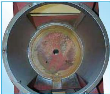
Förkromat invändigt. Används för slitande material.
