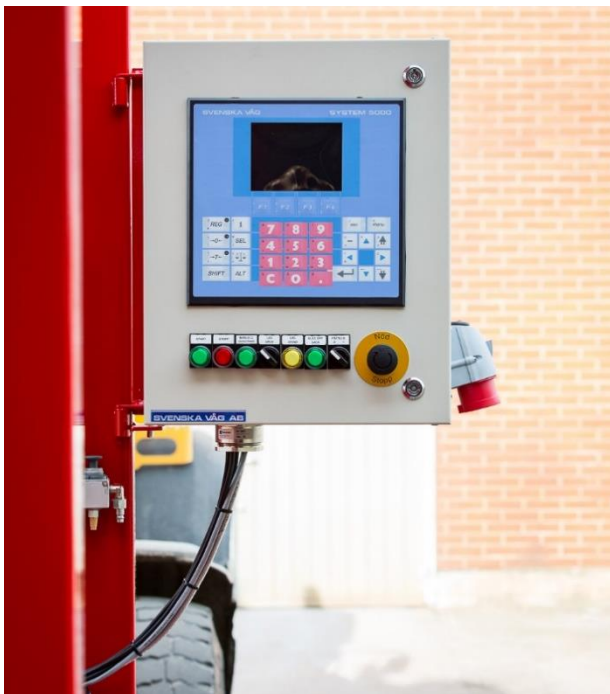
Enkelt styrskåp för smidig hantering av fyllningen.
