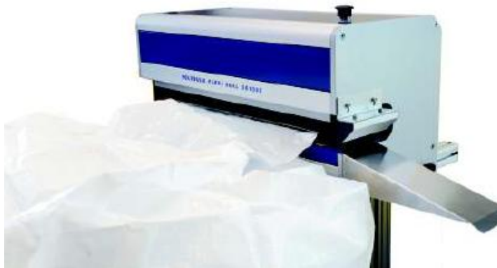
Svets av storsäcksstos. Förslutningsautomat med svetsfunktion. Inkl upphängningsram och med all erforderlig elektronik.
