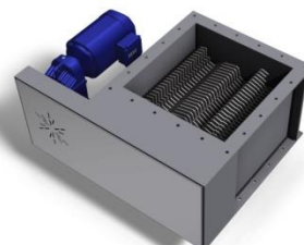
Klumpkross är den optimala lösningen för att krossa klumpar av t ex salt eller talk som har uppstått under hantering av materialet och som är tillräckligt mjuka för att kunna krossas.
