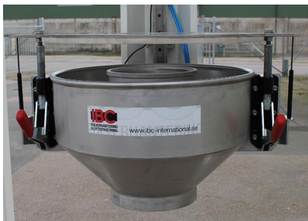
Klämenhet i öppet läge – redo för riggning av säck.
