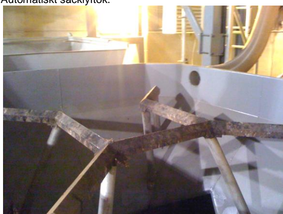
Värmeknivar som skär upp säcken.
