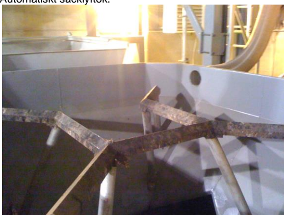
Värmeknivar som skär upp säcken.
