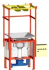
BAGBOY Hygiene typ B försedd med doserings-skruv.
