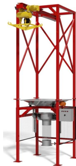
BAGBOY HYGIEN typ C Traversstativ (10c) med säckstöd (4b), eldriven kättingtelfer (17) och lyftok (18a). Klämenhet (21) för fixering och sträckning av tömningsstos, styrd från ett pneumatiskt styrskåp (20).
