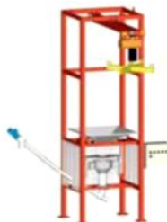
BAGBOY Hygiene typ C försedd med flexibel skruv.
