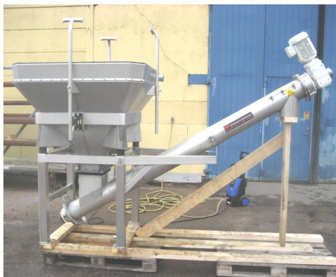
Storsäckstömmare med skruv till offshore-industrin.
