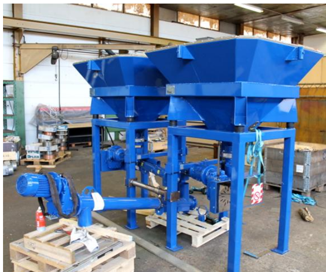
Dubbel Bagboy OneWay typ A med skruvsystem.
